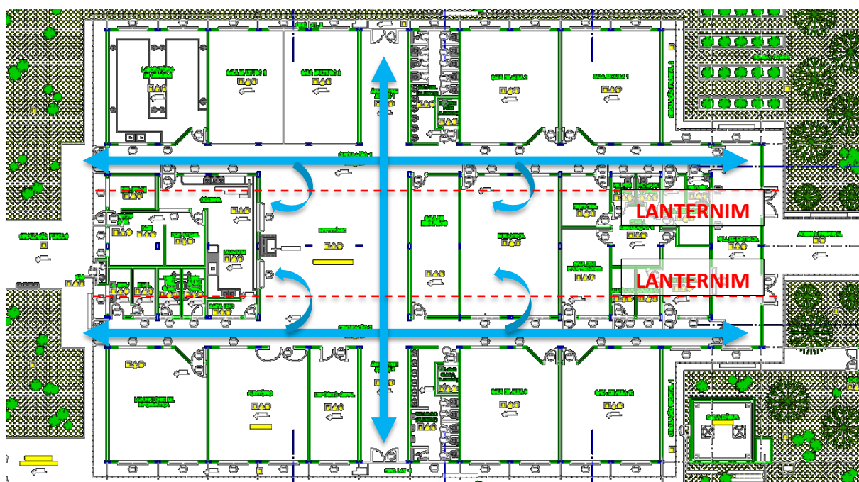
Figura 1. Circulação de ar no edifício - padrão
