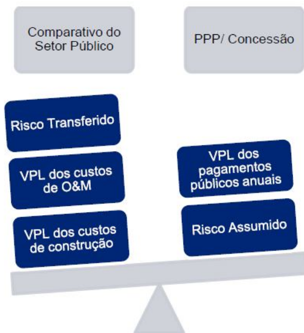
Figura 30: Construção do Value for Money
